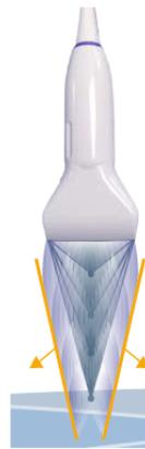
*Force de radiation créée par SonicTouch™. L'onde de cisaillement est amplifiée le long d'un cône de Mach (en jaune), la distance parcourue est augmentée minimisant ainsi l'énergie acoustique utilisée*
